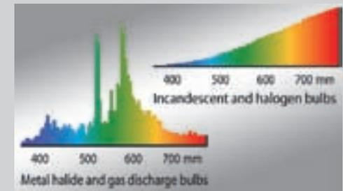
Le lampade Tecno-Gaz adottano lampade alogene perché lo spettro di emissione del visibile è il più simile a quello della luce solare, questo assicura coerenza visiva.
