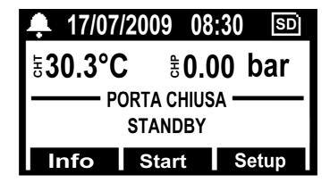
Ouvrir la porte et attendre quelques secondes, jusqu'à ce que un avertissement sonore informera sur l'acquisition des paramètres d'alignement barométrique automatique; en même temps le message <u>PORTE OUVERTE</u> sera affiché.
