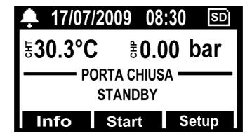
Abrir la tapa y esperar unos segundos hasta que la señal acústica informe de la correcta adquisición de los parámetros de nivelación barométrica automática. En la pantalla aparece el mensaje TAPA ABIERTA.
