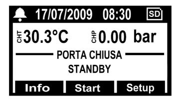
Die Klappe öffnen und einige Sekunden warten, bis eine Tonmeldung die erfolgte Gewinnung der Parameter für die automatische barometrische Ausrichtung meldet; gleichzeitig erscheint auf dem Display der Schriftzug <u>KLAPPE OFFEN</u>.
