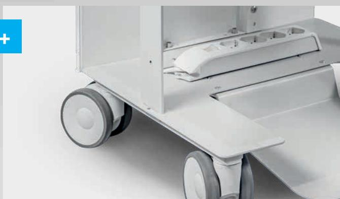
Ruote girevoli, ad alta scorrevolezza con freno di stazionamento. Montate su cuscinetti a sfere con resistenza al carico di 100 Kg. Grazie al grande diametro (100mm) sono in grado di superare ostacoli quali: fughe, aree di congiunzione fra diverse pavimentazioni, piccoli ostacoli.
