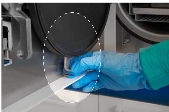
El nuevo sistema de ajuste asistido de la puerta permite efectuar los ajustes más fácilmente y de forma más precisa.
