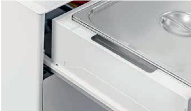
Sehr leichtgängiger und sanfter Schließmechanismus (gedämpfte Endklappe). Die Auszüge werden im Dauereinsatz getestet, wobei sie sich mit einer Frequenz von 7 Zyklen pro Minute öffnen und schließen. Diese Tests garantieren den Betrieb der Schienen für 60.000 Zyklen, d.h. für einen Dauereinsatz von mehr als 20 Jahren.
