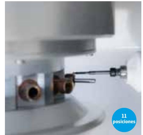
**La cámara de fresado es un monobloque obtenido por fusión de aluminio**
