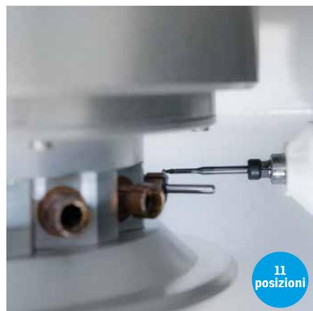
**La camera di fresaggio è un monoblocco ottenuto da una fusione di alluminio**
