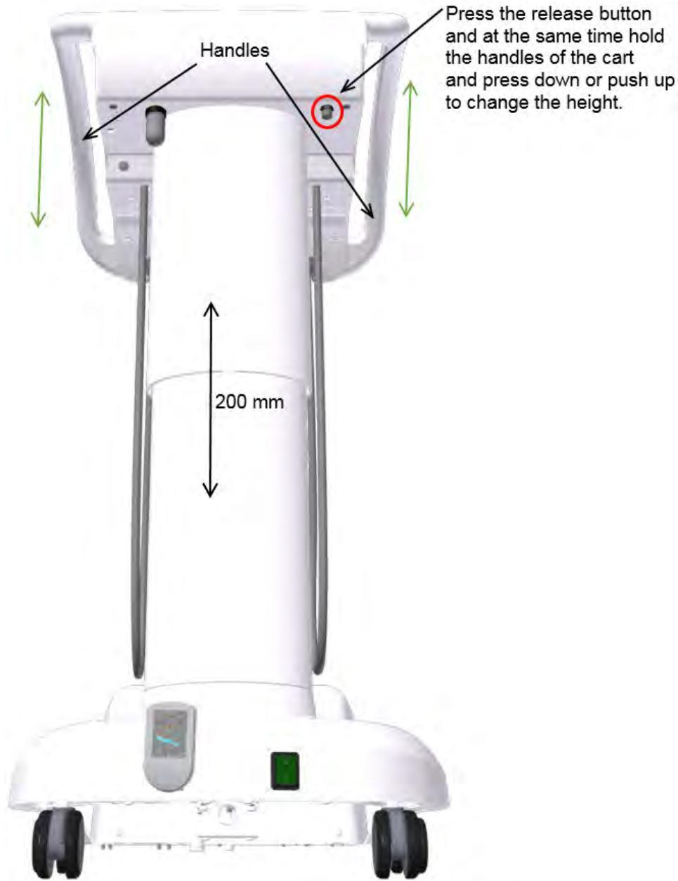
Es posible cambiar la altura de trabajo del panel de control en un rango de 200 mm. Agarre el panel de control (desde detrás) por los lados con ambas manos mientras mantiene presionado con un dedo el botón de la parte inferior del panel, desbloqueando así el mecanismo de ajuste de altura. Vuelva a colocar el panel agarrándolo de la manera descrita en la altura de trabajo deseada. Bloquee el panel en la altura ajustada liberando el botón del mecanismo.
