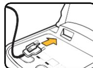
**Figura 9. TECNOHEART plus: Ícone de desconexão dos eléttodos**
